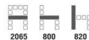
SF083 CUBIC III 3-SEAT (มีเท้าแขน) 2065(W) x 800(D) x 820(H) mm.
