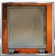
ทดสอบเผาไหม้ตู้ เป็นเวลา 2 ชั่วโมง Put in the burner for 2 hours
